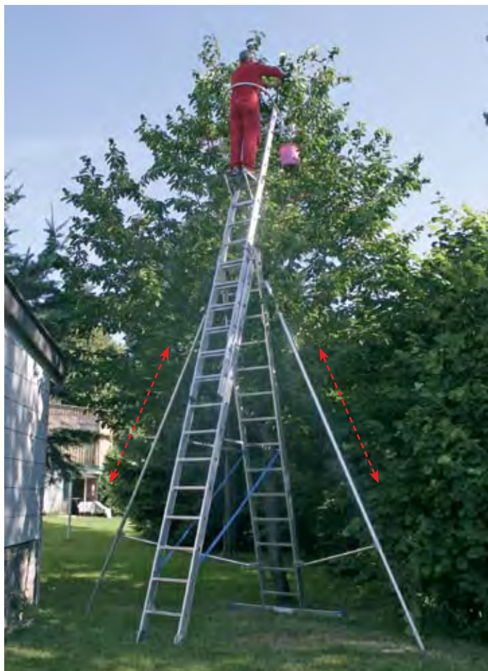
Фрагмент стабилизирующей опоры для приставных лестниц и лестниц-стремянки (поворотный тип)
